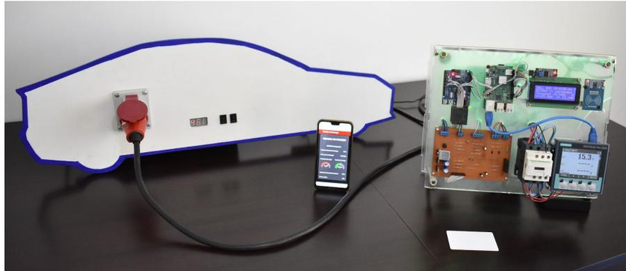
Figura 2: Prototipo EVSE y emulador de EV
