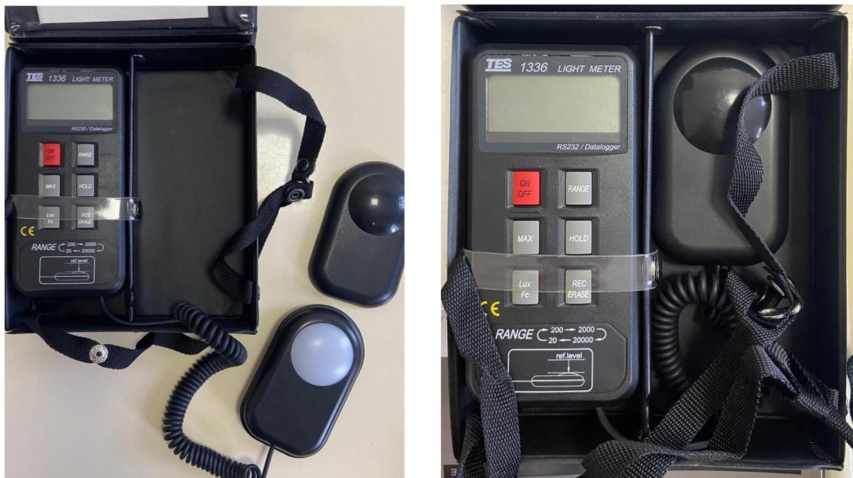
**Figura 17. Luxómetro utilizado para las mediciones de iluminancia.**
