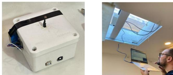
Figura 5. Cuarta medida: prototipo control de iluminación por programación de un Arduino con una fotorresistencia como sensor.
