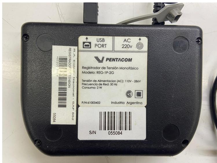
**Figura 8. Registrador de tensión monofásico PENTACOM.**
